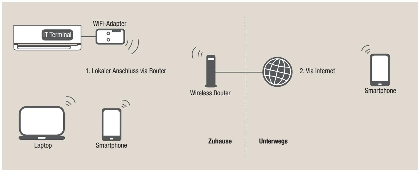
Über mobile Endgeräte Split-Klimaanlagen einfach und bequem bedienen.
